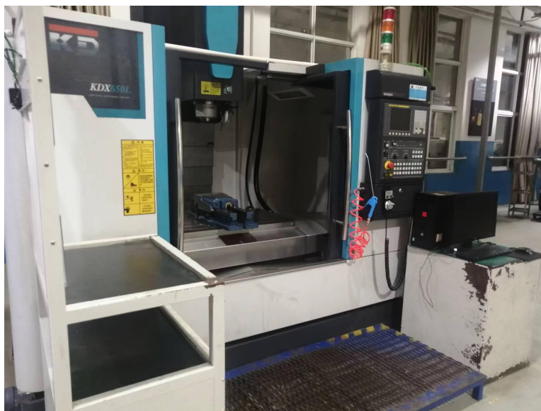
图1 KDX650L型数控铣床
